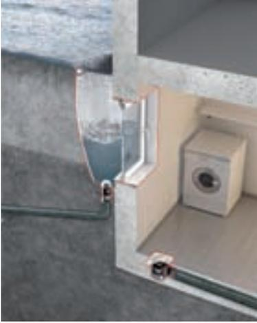
*Gesamtrendering“: Kellerschutz durch hochwasserdichten Lichtschacht, hochwasserdichte Leibungsfenster und Rückstausicherung von ACO.*
