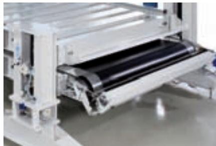
Nachdem die Verschaltung abgeschlossen ist, liegen alle Schichten für die Laminierung übereinander und werden durch Hitze und Druck verschmolzen. So bilden die EVA-Folien zusammen mit dem strukturierten Solarglas, der Rückseitenfolie und den eingeschlossenen Zellen einen fest versiegelten und vor Witterungseinflüssen geschützten Verbund. Alle Lamine werden nach
