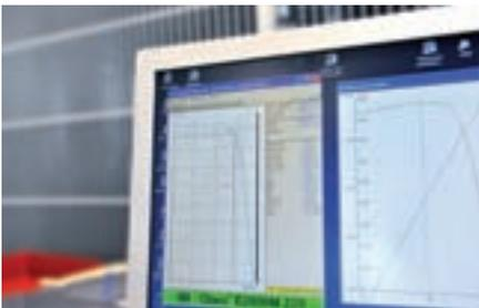
Mittels Sonnensimulation wird die tatsächliche Leistung jedes Moduls unter normgerechten Bedingungen festgestellt. Das Moduletikett weist u.a. die Seriennummer, die Leistungsklasse und die tatsächlichen elektrischen Leistungsdaten des Moduls aus. Die Anschlussdose wird noch mit einer Vergussmasse versiegelt, die Feuchtigkeit von der Elektronik fernhält.
