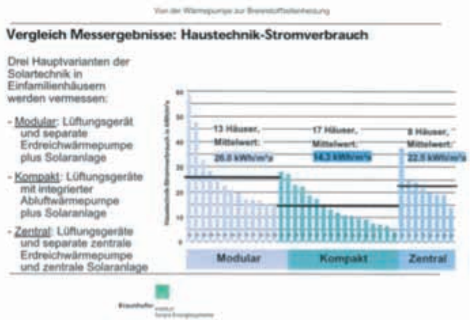
Abbildung 3: Messergebnisse verschiedener Haustechniksysteme in 40 Passivhäusern [Quelle: Fraunhofer ISE, Freiburg]
