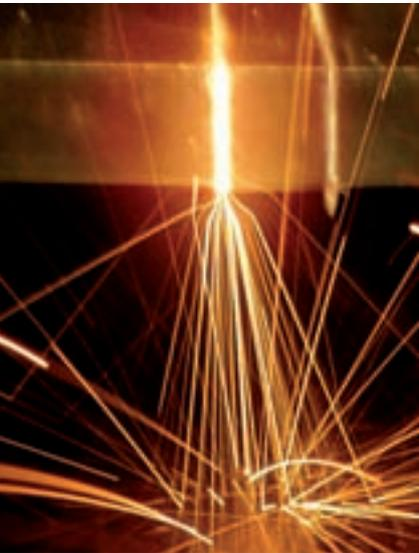
**D**er Elektronenstrahl eröffnet dem Konstrukteur und dem Fertigungs-Ingenieur oft ungeahnte Lösungsmöglichkeiten mit großen wirtschaftlichen Vorteilen. Zum Beispiel überwindet der Einsatz des Elektronenstrahls beim Mehrbadprozess die Grenzen anderer Verfahren. Auch gelingt es, Aluminium-Druckgussteile dauerhaft gasdicht zu verschweißen.
