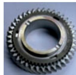
Bild 1: Schaltrad mit Synchronring
