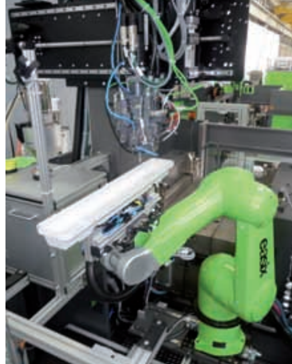
MOLD'n SEAL: Inline-Verarbeitung von spritzgegossenen Leuchtgehäusen mit Direktauftrag einer PUR-Schaumdichtung auf kleinstem Raum
