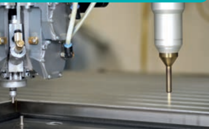
Die direkt am Mischkopf angebrachte Plasmadüse behandelt die Oberfläche der Silikonschaumdichtung mit Plasma, – neben anderen positiven Effekten kann die Aushärtezeit damit auf ein Minimum reduziert werden.
