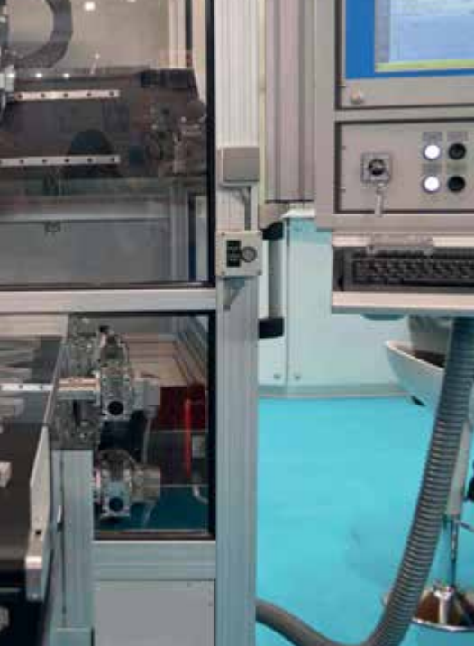
Die Dosierzelle SMART DM 402, ausgestattet mit einem leistungsfähigen Optiksistem, erkennt automatisch die unterschiedliche Lage und Größe der Bauteile auf dem Transferband, auch bei chaotischer Teilezuführung.
