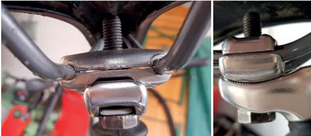
Bild 1 und 2: Befestigung der Sattelanbindung mit ersetzter Schraube
