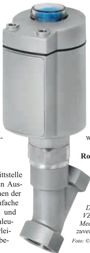
sondere beim Orbital-schweißen deutlich. Die Spindeldichtung ist in Form einer Kartusche aufgebaut. Sie besteht aus einer Edelstahlhülse mit vorgespannter Dachmanschettenpackung aus PTFE Dichtringen und kann dadurch ohne Spezialwerkzeug einfach und sicher ausgetauscht werden.
