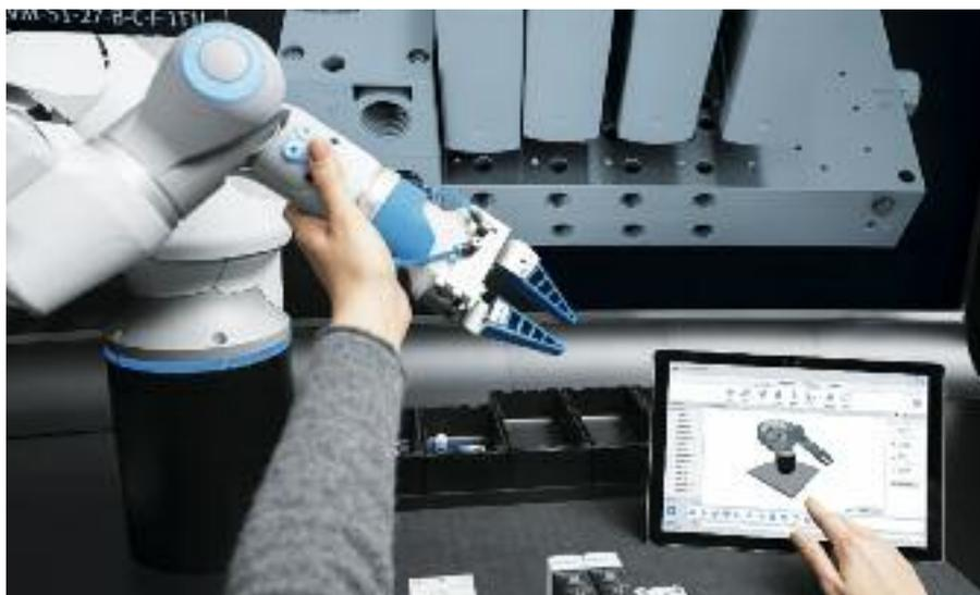
*BionicCobot ist ein pneumatischer Leichtbauroboter mit menschlicher Bewegungsdynamik. Die intuitive Bedienung erfolgt durch die Robotic Suite.*
