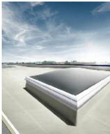
*Mit Flüssigkunststoff-Lösungen lassen sich selbst komplexe Geometrien, zum Beispiel Lichtkuppeln am Flachdach, einfach und dauerhaft einbinden. Möglich macht das ein flexibles Spezialvlies, das Bestandteil des Systems Triflex ProDetail ist und in das noch flüssige Material eingearbeitet wird. Es nimmt temperaturbedingte Ausdehnungen und Bauwerksbewegungen schadlos*
