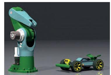
Alle Bauteile dieses Modells wurden fertigungsgerecht konstruiert, wobei die Gehäusebauteile sowie die Roboterarme als Druckgussteile bzw. Sandgussteile ausgeführt wurden. Die Zusammenbau-Gruppe des Roboters kann über die Anwendung „CREO-Mechanismus“ animiert werden. Diese steht den Schülern auch als Augmented Reality Modell für die Begutachtung mit der Microsoft HoloLens 2 zur Verfügung. ■
