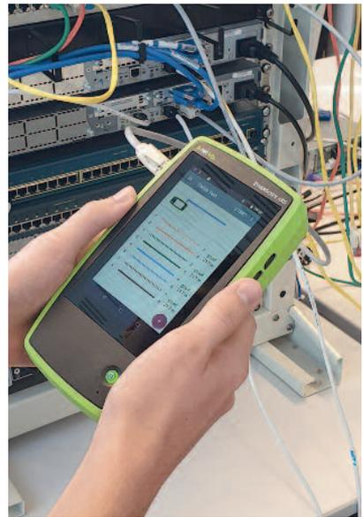
WLAN-Messgerät Netally Etherscope nXG im Cable-Test Mode
