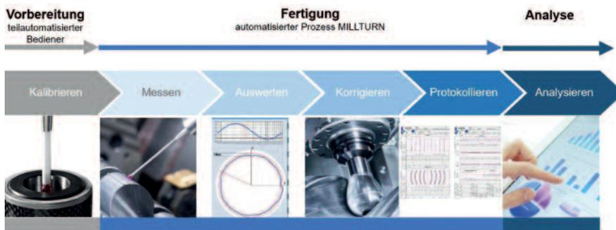
Messvorgang in einem Fertigungsprozess
