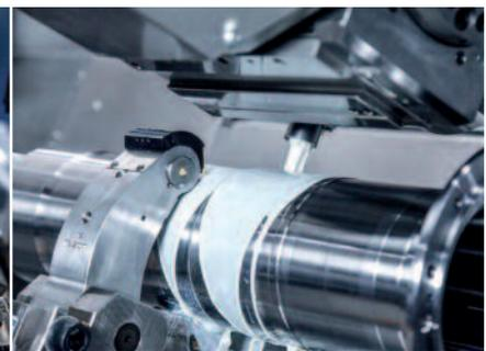
Bei der Ultraschall Wanddickenmessung wird das Signal über das Kühlmittel übertragen.
