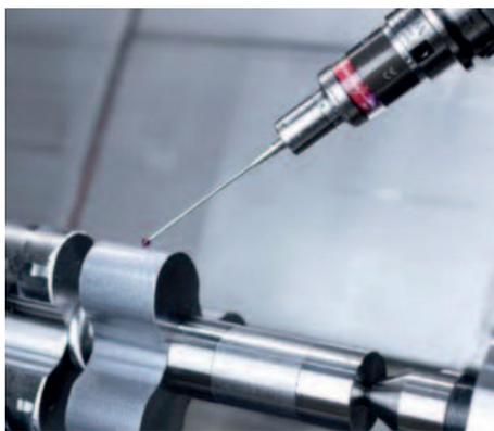
Der DIGILOG-Taster bewegt sich „scannend“ mit bis zu zwei Metern pro Minute und erzeugt so in kürzester Zeit tausende Messwerte.
