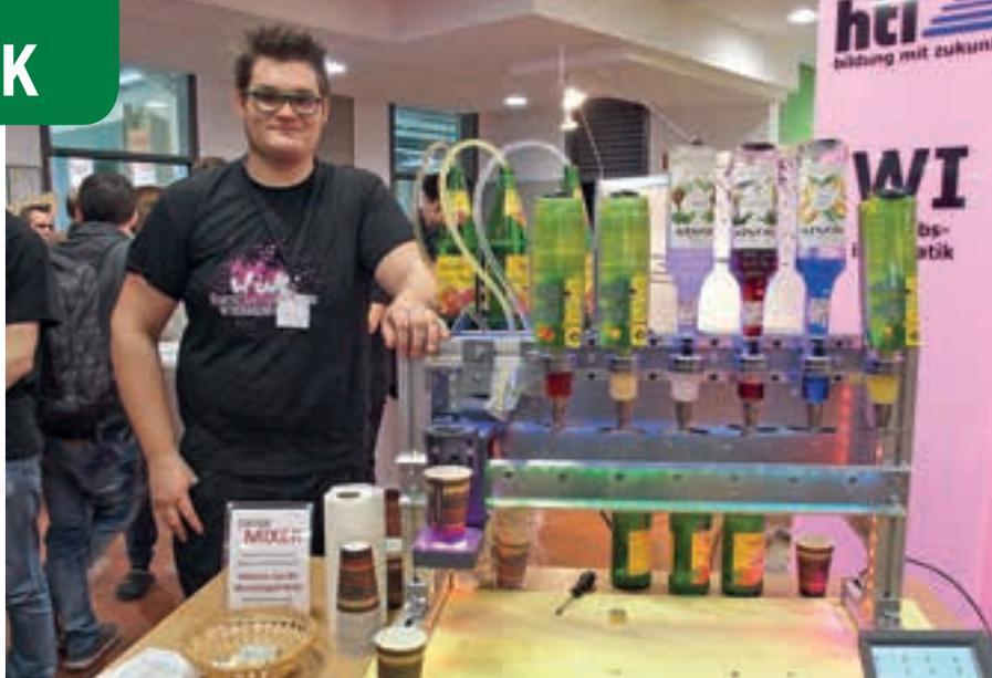
Zylinder betätigt werden. Die Software berechnet eigenständig wie oft die Dosierer betätigt werden müssen um die richtige Menge zu erhalten. Nach der Fertigstellung begibt sich der Schlitten wieder zurück zur Ausgangsstellung der durch den 2. Sensor bestimmt wird. Danach ist der gewünschte Cocktail fertiggestellt und wird durch ein sichtbares Leuchtsignal der LEDs gekennzeichnet.
