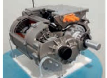
**Das elektrische Achsantriebssystem (eAxle) von Bosch**
